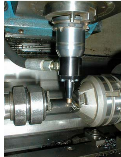
Fig. 5-6 :Circulated deep rolling of a turbine blade
